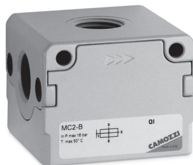
I moduli di derivazione quando sono dotati di valvola di non ritorno, possono essere utilizzati per il prelievo di aria non lubrificata e devono essere inseriti tra regolatore e lubrificatore.
